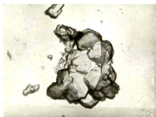
Микрофотографии образцов, полученных в результате гидротермальной обработки: а) исходный клиноптилолит; б–г) образцы, подвергнутые гидротермальной обработке (ув. × 2000).
