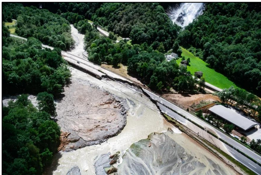
Рис. 5. Один из участков вогнутого берега, размываемого водным потоком.
