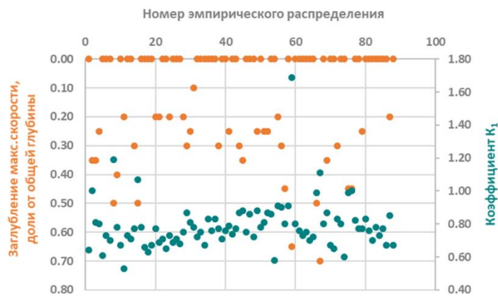
Рис. 5. График изменчивости коэффициентов K_1 и заглубления максимальной скорости течения в долях от общей глубины.
