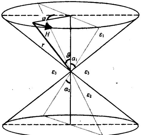
Обозначим диэлектрические проницаемости диэлектрического конуса через  $\epsilon_1$ , металлического конуса –  $\epsilon_2$ , а окружающей среды –  $\epsilon_3$ . Полагаем, что в сферической системе координат  $(r, \vartheta, \varphi)$  отлична от нуля только  $\varphi$ -компоненты магнитного поля  $H_\varphi$ , для которого волновое уравнение можно представить в виде:
